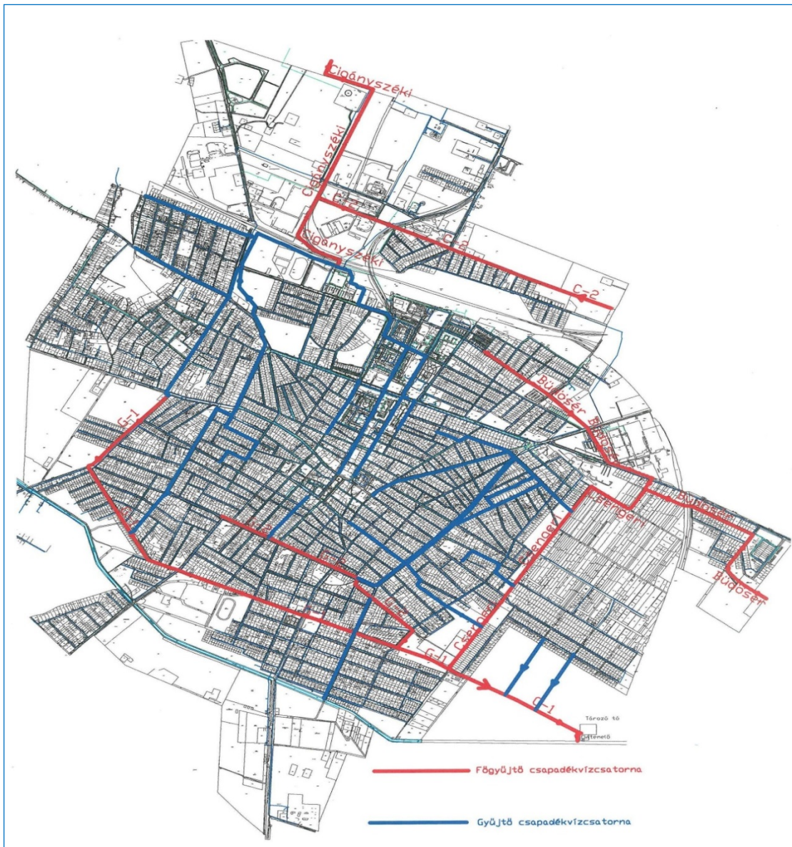
17. ábra - Cegléd város csapadékvíz-elvezető rendszere
